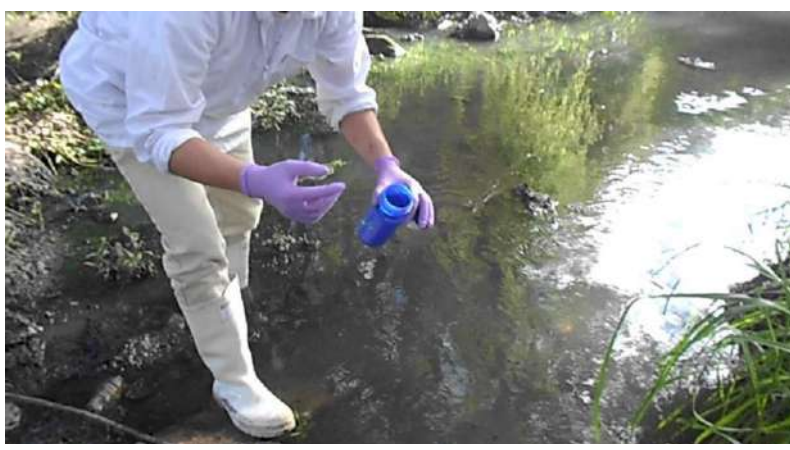
Ilustración 26: Toma de Muestra de Agua
